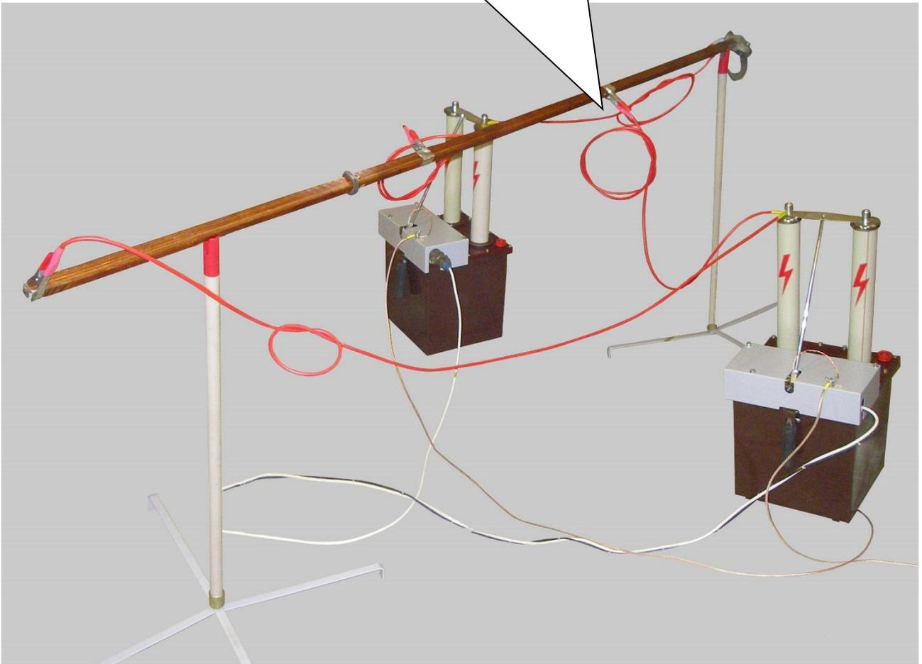
Рис. 4.3(б) Испытание высоковольтной штанги (штанга условно поделена на 3 части)
