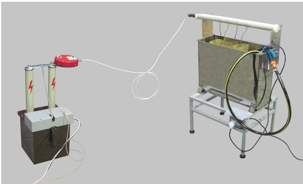
Рис. 8.15. Стенд подготовленный к испытанию перчаток.
