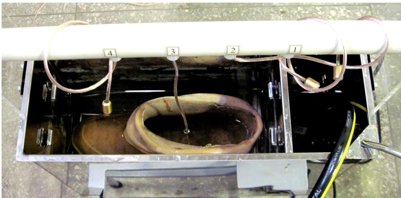
Рис. 8.16. Диэлектрический бот подготовленный к испытанию.
