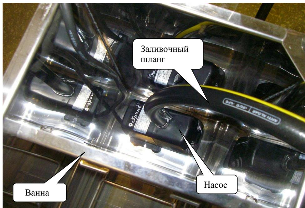
Рис. 7.2.Размещение насоса внутри ванны.
