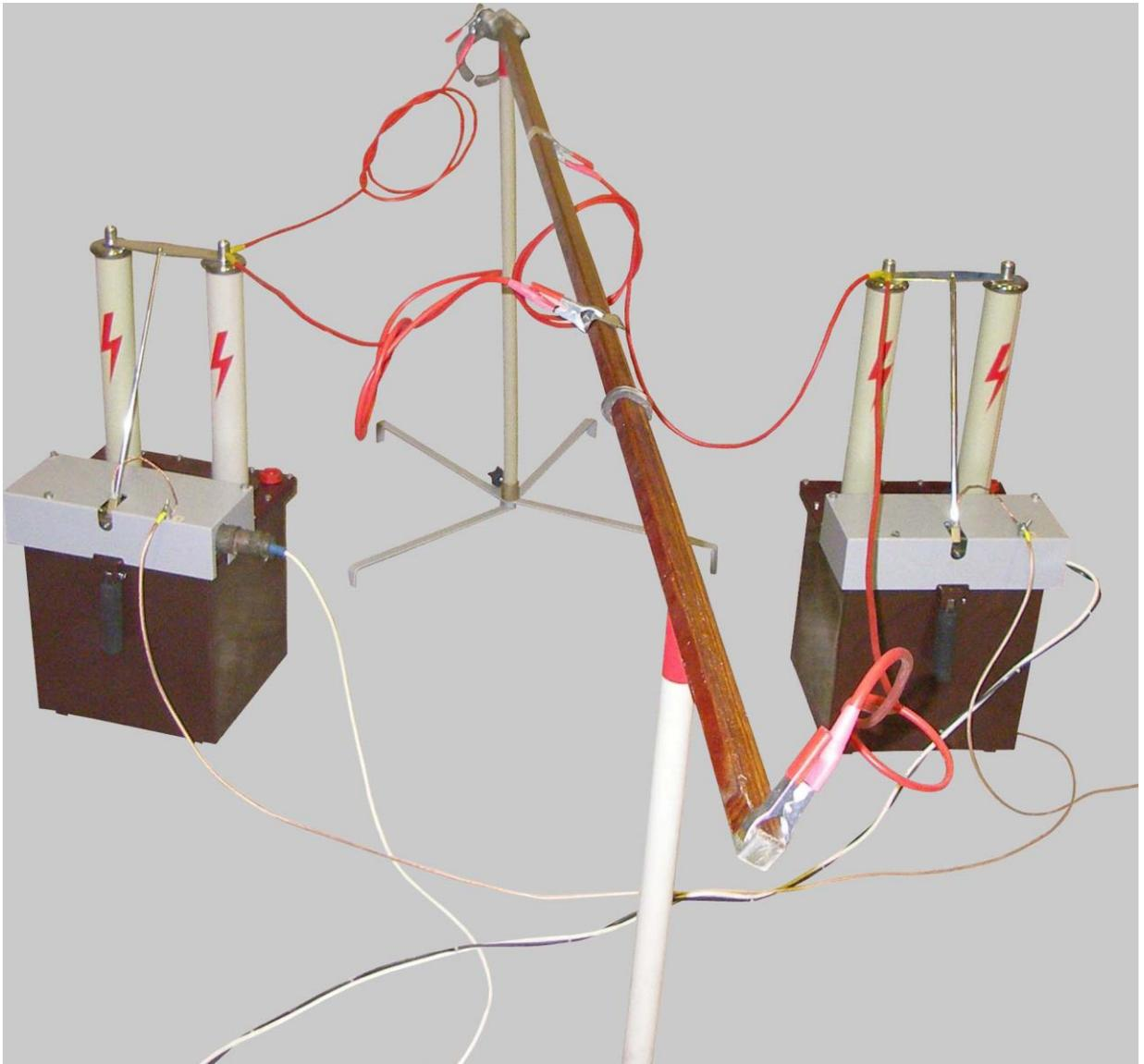
Рис. 4.3(а) Испытание высоковольтной штанги (штанга условно поделена на 3 части)
